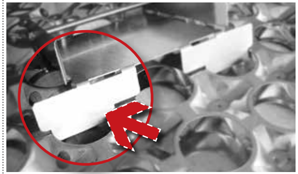
7 Hintere Verankerung der Umlenkrolle zur 180° Bogenverlegung.
