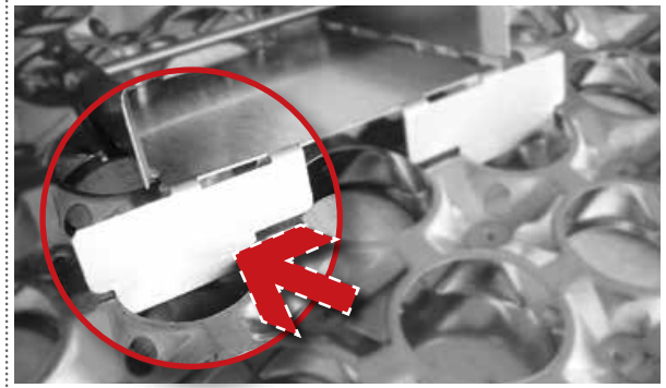
7 Hintere Verankerung der Umlenkrolle zur 180° Bogenverlegung.
