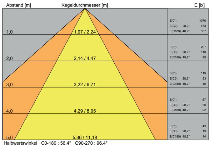
Bestückung LED, Gesamtlichtstrom 1850 lm, Normierung LED 100%, Anstellwinkel 0,0°
